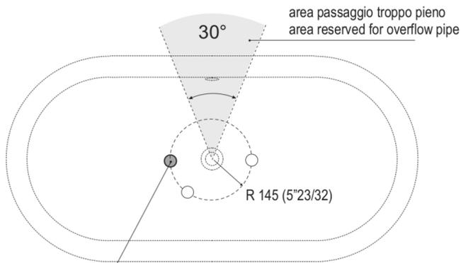
scarico  $\varnothing$  40 mm con OR di tenuta
