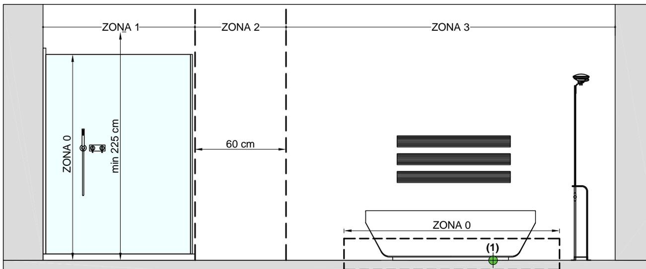
(1) NB: Predisporre un collegamento IP68 (non presente in dotazione, a cura dell'installatore) per la fonte luminosa, inserire quindi il cavo in eccesso all'interno della forasite e siliconare la parte superiore a chiusura.
